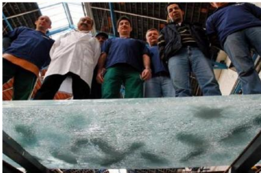
显示玻璃破碎后SGP夹层玻璃的残余强度
